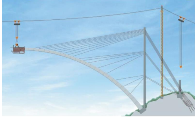
Figura 26 Costruzione arco ponte Svinesund confine Norvegia Svezia
