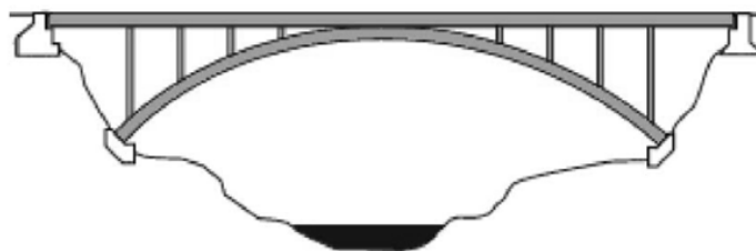
Figura 8 Ponte ad Arco a via Superiore o Spingente
