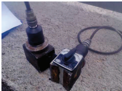
Figura 4. 4- Base accelerometro e sensore accelerometrico
